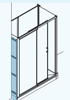
◀ **Overlopende montagerail** (laat toe een douche te installeren die breder is dan de oude badkuip, die overloopt in de badkamer. De blauwe zone is om aan te kleden met gipsplaat, muurpanelen...). Overloopzone maximaal 30 cm\*
