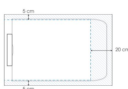
Maximaal zaagbaar oppervlak (bij niet volledige inbouw dienen de gezaagde zijden tegen een muur gepositioneerd te worden)
